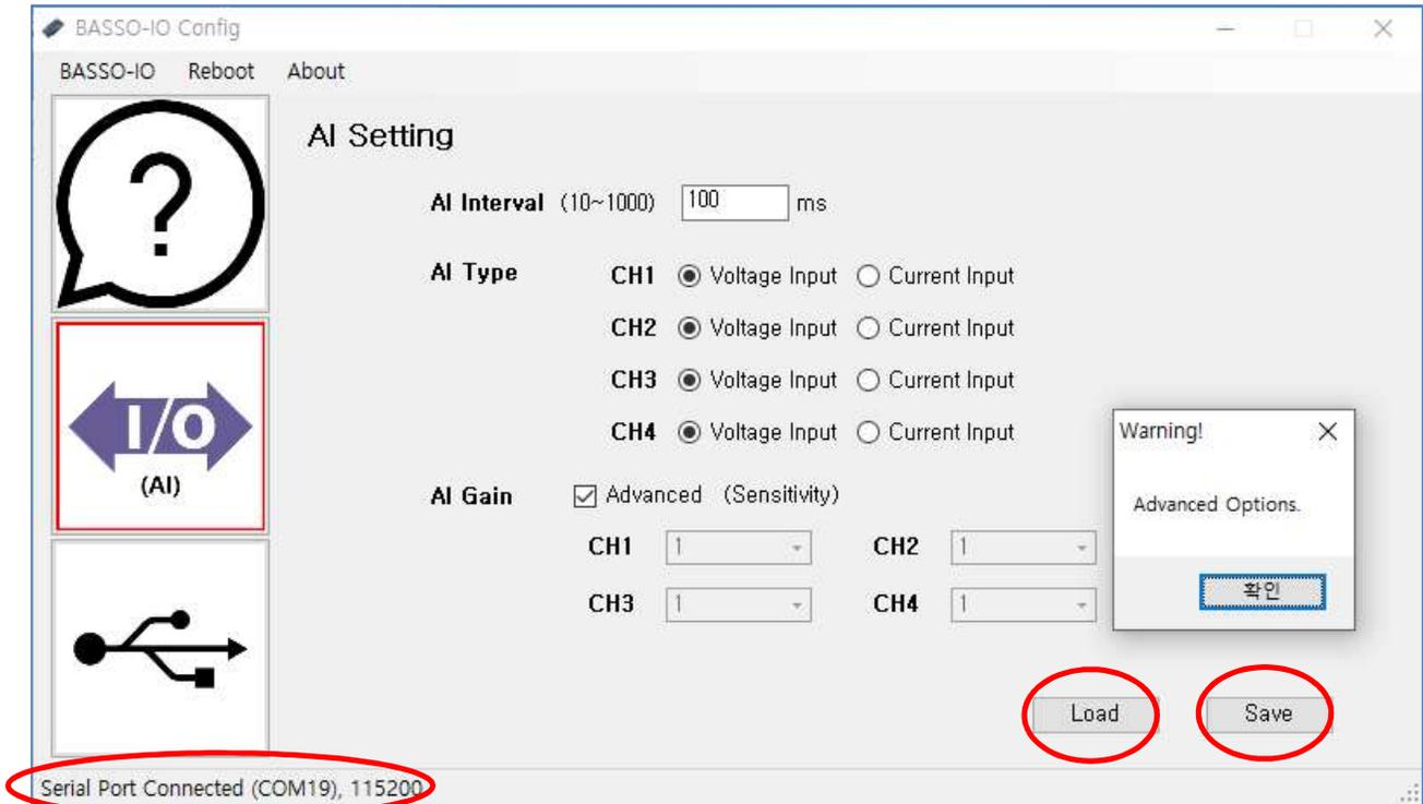
[AI Interval] 설정 시 Analog Input 측정 주기를 설정할 수 있습니다.
