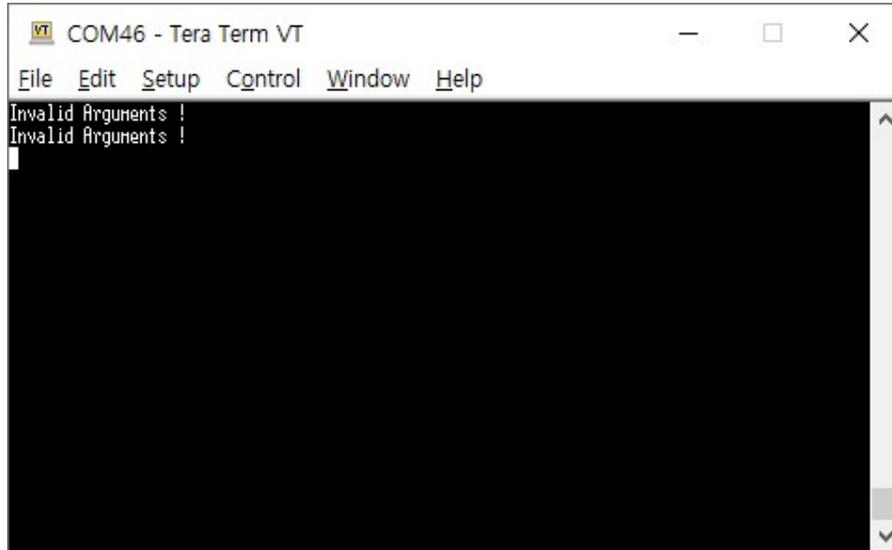
※ Analog Input포트 (터미널블럭)의 Field Power, Field Ground를 연결해야 Serial Command가 정상동작 됩니다.
