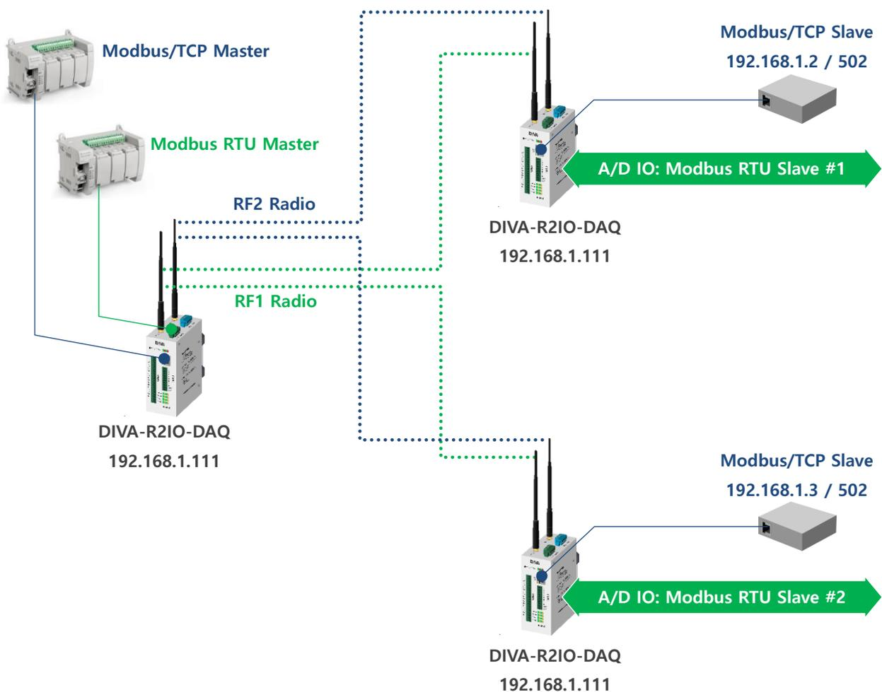
사용자는 Modbus/TCP 프로토콜을 통해 아날로그/디지털 입력 상태를 확인하거나 ON/OFF 디지털 출력을 제어할 수도 있습니다. 한 개의 무선 인터페이스는 아날로그/디지털 입출력 데이터를 연결하는데 사용하고 나머지 한 개의 무선 인터페이스는 RS232/422/485 시리얼 장치를 연결하는데 사용합니다.
