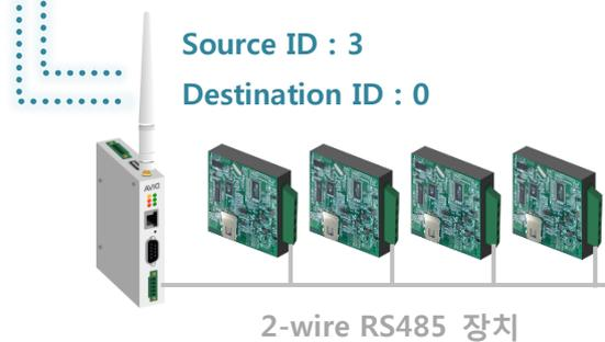
DIVA-IRM 제품은 IP 주소와 상관없이 유선랜 포트에 연결된 모든 이더넷 장치에 데이터를 브로드캐스팅 합니다. DIVA-IRM 장치와 이더넷 장치는 TCP 소켓 통신으로 연결되며 입력되는 데이터를 무선을 통해 송신하고 반대로 무선으로 수신한 데이터는 TCP 소켓을 통해 이더넷 장치로 출력합니다. 무선으로 송수신되는 데이터에는 TCP/IP 헤더 정보가 포함되어 있지 않습니다.
