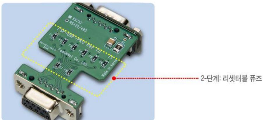
3단계 보호 회로에서는 1단계와 2단계를 거쳐온 신호에서 RS232 신호 사양에 적합한 신호만 통과시키는 역할을 제공합니다. 표준 RS232 사양은  $\pm 25V$  레벨의 전압까지 허용합니다. FSP-D9M/RS232-PRO 제품은  $\pm 15V$  이상의 전압을 차단하여 외부 서지로부터 RS232 호스트 장치를 보호합니다. 3단계 보호 회로에서 차단하는 용량은 피크 펄스의 10/1000 $\mu s$  구간에서 최대 600W 규격으로 뛰어난 차단 성능을 제공합니다. 그 외에 IEC 61000-4-2, 30kV Air, 30kV Contact 레벨의 정전기를 차단하거나 IEC 61000-4-5 규격의 전기적 빠른 과도 신호를 차단하는 기능을 제공합니다.
