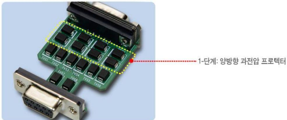
2단계 보호 회로에 탑재된 리셋터블 퓨즈는 1단계를 거친 신호 중 전류가 일정 용량을 넘어서면 자동으로 차단하여 장비를 보호합니다. FSP-D9M/RS232-PRO 제품은 약 0.8A 이상의 전류가 흐르게 되면 최대 0.1초 이내에 퓨즈가 개방되어 회로를 보호합니다. 유입되는 써지의 전류 값이 클수록 퓨즈 개방 시간은 더 빨라지는데 약 8A 용량의 전류가 유입될 경우 0.7us 이내에 퓨즈가 개방됩니다. 개방된 퓨즈는 퓨즈 자체 열이 낮아지면 자동 복구됩니다.
