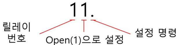
해당 릴레이의 상태를 변경 하려면 3Byte의 명령이 필요합니다. 예를들어 1번 릴레이의 상태를 Open 상태로 변경 하려면 첫번째 바이트에는 릴레이 번호를 나타내는 '1' 문자를 보내고 두번째 바이트에는 Open 을 나타내는 '1'문자를 보냅니다. 마지막으로 '.' 문자로 릴레이 상태를 변경하는 명령임을 나타냅니다. 이 명령이 성공적으로 수행되면 OK의 약자인 'O' 문자가 수신되고 실패하면 Error의 약자인 'E' 문자가 수신됩니다. 2번 릴레이를 Close 상태로 변경 하려면 20. 명령을 보냅니다.
