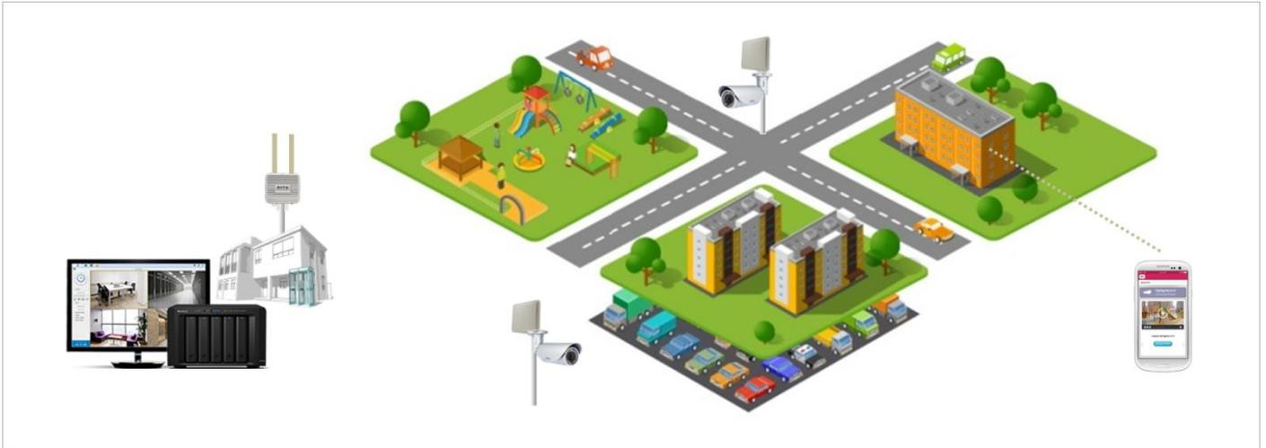
DIVA-120AC-P 및 DIVA-IAP-AC 모델은 건물 구조 및 설비에 의해 전파의 반사/굴절/회절 현상이 발생하는 실내외 환경에서 사용할 수 있도록 MIMO (Multiple-Input, Multiple-Output) 기술을 지원합니다. 주로 액세스 포인트 모드로 사용되는 DIVA-IAP-AC 모델은 2.4/5GHz 무선을 동시에 사용할 수 있으며 Wave-2 MIMO 기술을 통해 여러 개의 무선랜 클라이언트 장치들과 동시에 고속 데이터 통신을 연결합니다.
