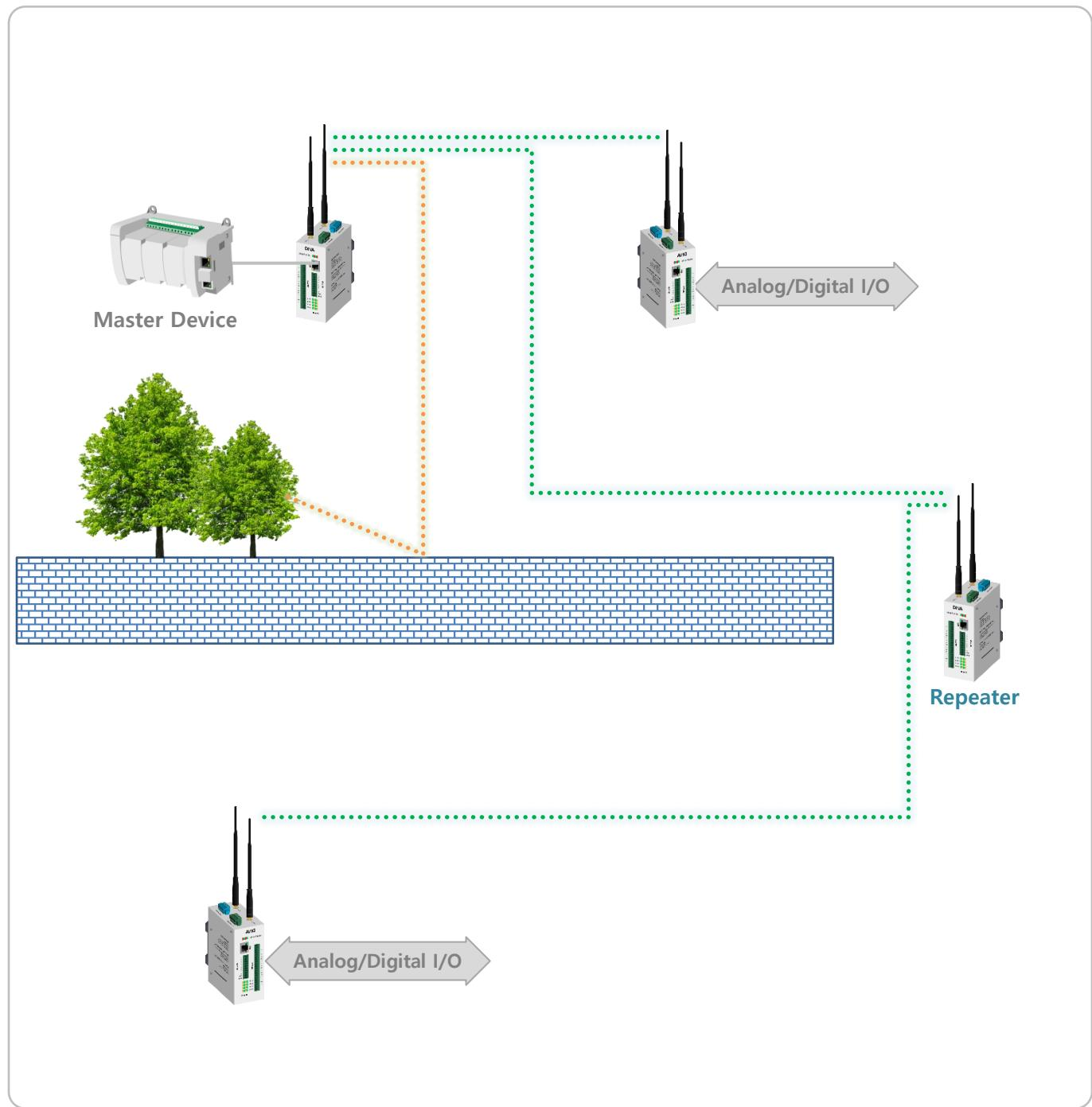
안테나 최대 통신 거리를 초과할 경우 리피터 모드를 사용하여 무선 전송 거리를 연장합니다. DIVA-R2IO-DAQ 장치의 무선 인터페이스는 각각 독립적으로 동작합니다. 따라서 2개의 DIVA-IRM 장치를 사용하여 각각의 무선 신호를 릴레이 할 수 있습니다.
